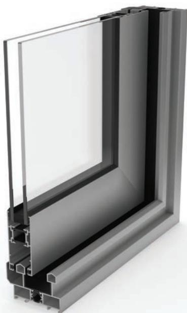
La Corredera CRS-77 es la solución ideal en balconeras de gran tamaño cuando son necesarios rodamientos de alta resistencia y hojas con gran capacidad de vidrio. Sus 77 mm en el marco y 38 mm en la hoja, permiten manipular de manera fácil y segura las hojas de vidrio que alcanzan los 200 kg.
